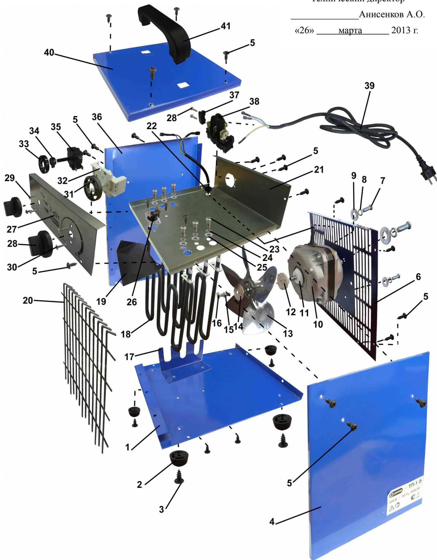
**Перечень основных деталей и узлов пушки тепловой
