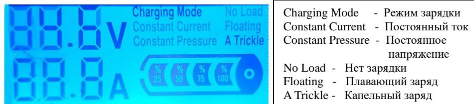
В режиме основного заряда аккумулятор заряжается максимальным номинальным током (постоянное значение тока). В течение этого этапа аккумулятор заряжается приблизительно до 80%, пока напряжение на его клеммах не достигнет определенного значения.
