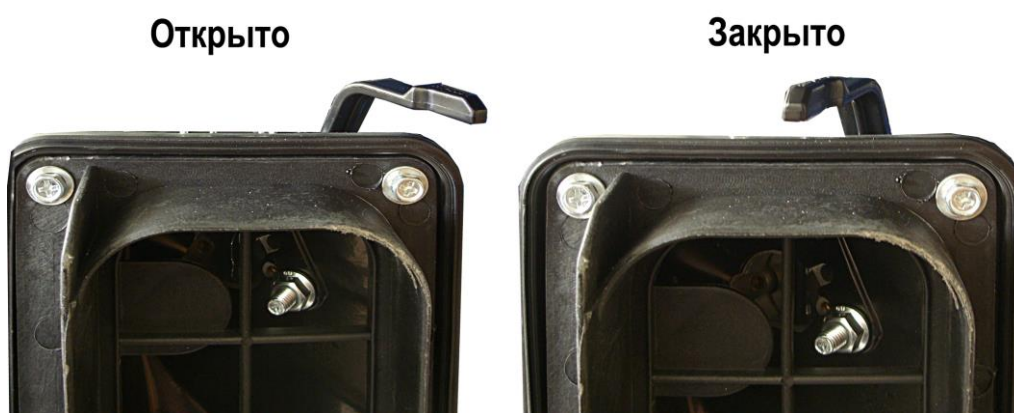
Установка дроссельного рычага в положениях «Открыто», «Закрото»
